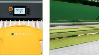
A(s) dobra(s) primária(s) é/são feita(s) por um fluxo de ar pulsado. Antes de ter sido realizada por completo a primeira dobra, mede-se o comprimento. É na base deste comprimento que se pode selecionar um dos muitos possíveis padrões de dobragem. Os modelos de dobragem são automaticamente postos na posição correta e os bicos de pulverização de ar pulsado dobram a peça firmemente à volta dos modelos. A longa dobra primária pode dobrar peças de até 2300 mm.
