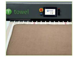
As peças são postas na correia transportadora de entrada. Esta correia transportadora começa a funcionar assim que deteta a peça ou após ativação manual com um botão na parte lateral da máquina.
