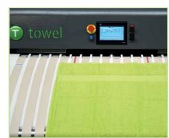
A **t.Towel** é fornecida com um dispositivo especial para dobrar peças que precisam de ser corrigidas antes de serem dobradas, tais como lençóis de baixo ajustáveis. Depois de pôr o lençol na mesa de alimentação e apertar o botão, a peça entra na máquina e pára automaticamente para corrigir a extremidade posterior da peça. Em seguida, o operador aperta o botão uma segunda vez para iniciar
