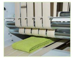
A t.Towel é equipada com duas seções de dobragem transversal. Cada dobra transversal é feita através da inversão das correias em combinação com um impulso de ar, o que resulta numa dobra muito precisa e firme. Ao longo da programação das posições de dobragem, podem ser realizados vários modelos de dobragem. Também é possível fazer um bypass (sem necessidade de dobragem transversal).
